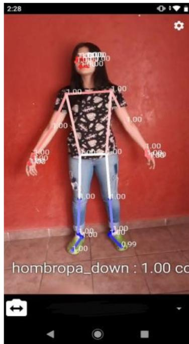
Figura 3.4: Detección de puntos en tiempo real en aplicación móvil
