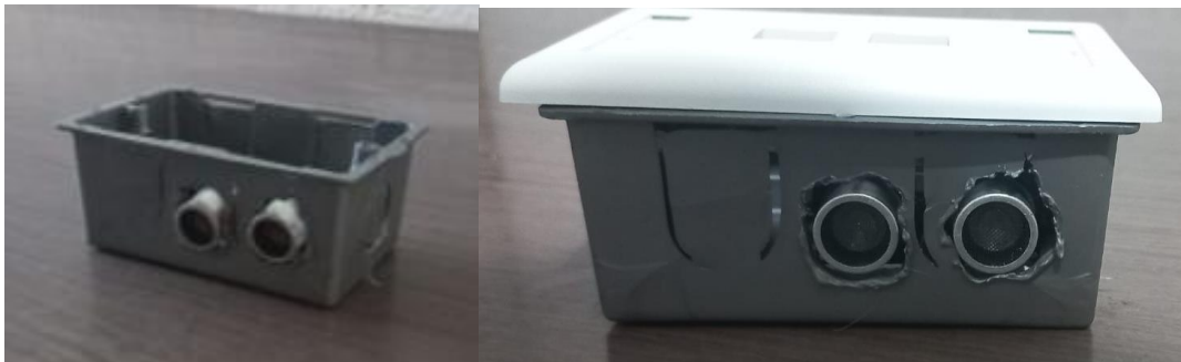
Figura 24: Sensor ultrasónico instalado en caja de seguridad Fuente(Creación propia)
