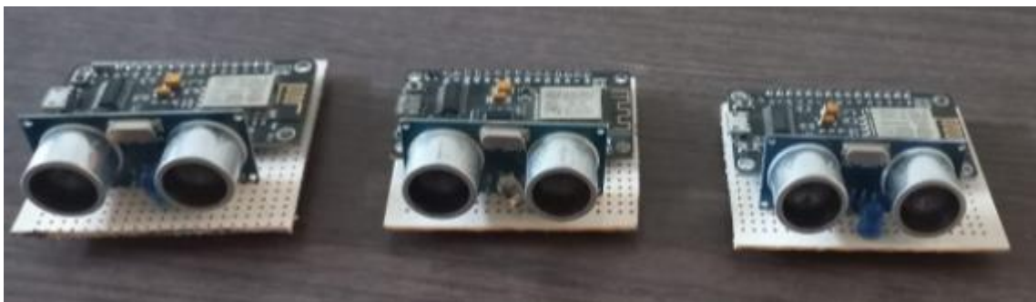
Figura 23: Conexión física de los sensores junto con el microcontrolador
