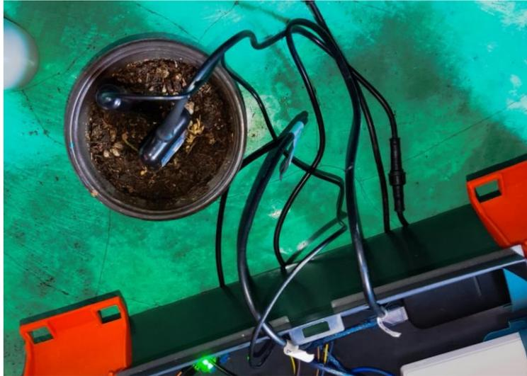
Figura 62 Muestra de suelo en maceta con mucha agua agregada. Fuente: Propia
