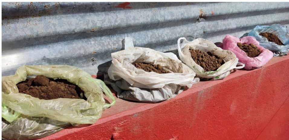
Figura 58 Secado al sol de las muestras de suelo. Fuente: Propia
