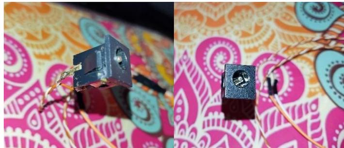
Figura 35 Conector de alimentación DC. Fuente: Propia
