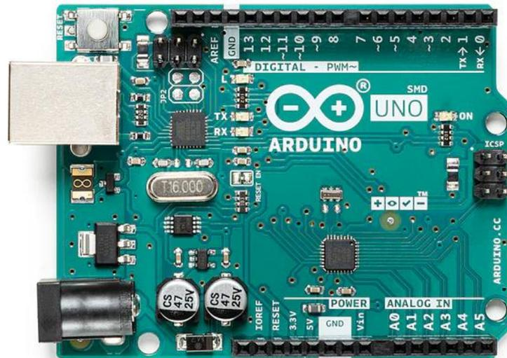
Figura 14 Placa Arduino Uno. Recuperado de <https://uelectronics.com/producto/arduino-uno-rev3/>
