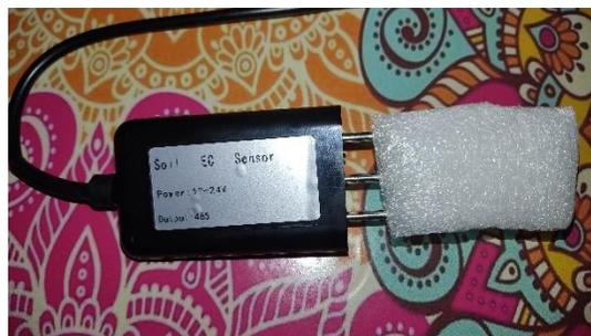
Figura 19 Sensor de Conductividad Eléctrica. Fuente: Propia
