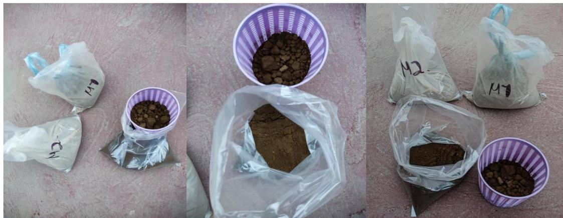
Figura 71 Filtrado de muestras de tierra para eliminar rocas, desecho inorgánico, etc. Fuente: Propia
