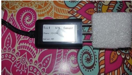
Figura 21 Sensor de nitrógeno, fósforo y potasio (NPK). Fuente: Propia
